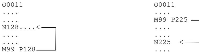
Die eventuell entstehenden unendlichen Zyklen können vermieden werden, wenn der die Anweisung M99 enthaltende Satz in Form /1 M99 eingegeben wird. In diesem Fall wird der Sprung abhängig von der Schalterstellung durchgeführt, oder weggelassen.
