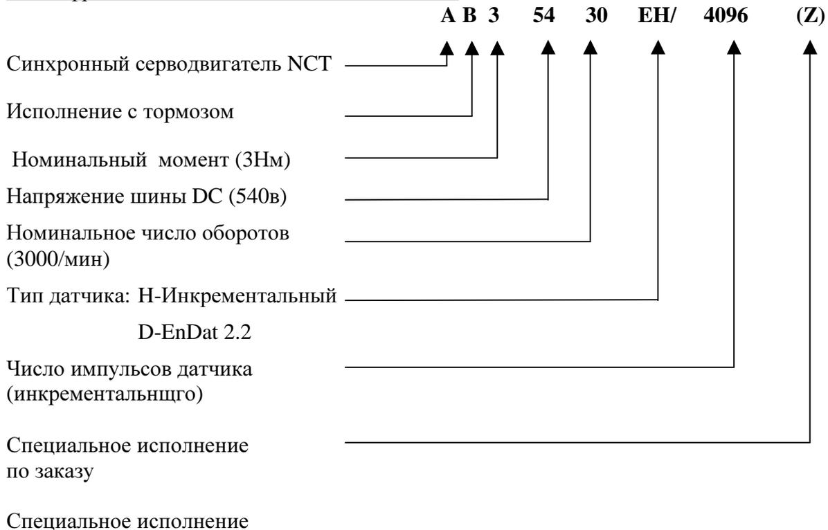
Двигатели серии „А” по желанию могут поставляться с фланцем и концом вала индивидуального исполнения, возможно и с обмоткой для другого напряжения. В этом случае последний знак типового обозначения „Z”.
