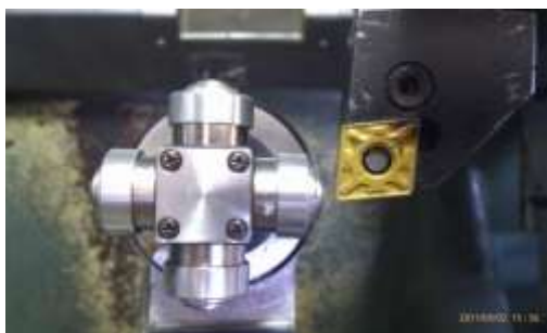
6. ábra Z negatív irányba történő automatikus szerszámbemérés
