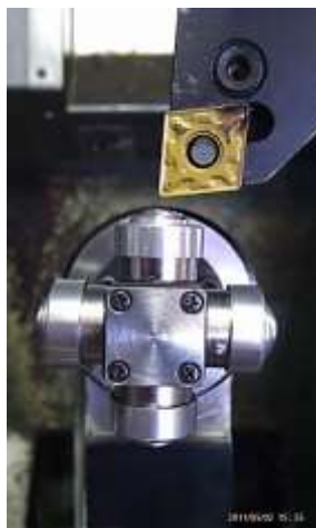
5. ábra X negatív irányba történő automatikus szerszámbemérés
