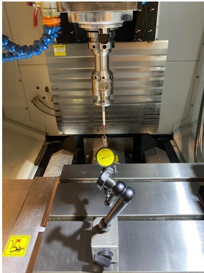
1. ábra. A munkadarab-bemérő és a mérőóra kapcsolata
