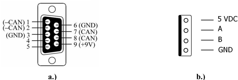
3. ábra. Gépi billentyűzet kézikerek csatlakozói: a.) CAN buszos kézikerek csatlakozó, b.) inkrementális kézikerek csatlakozó
